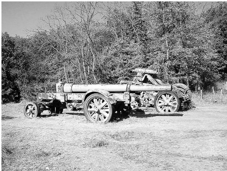
die beiden Teil-Lasten des 21-cm-Mörser in Fahrtstellung ( https://de.wikipedia.org/wiki/21-cm-Mörser_18 )
